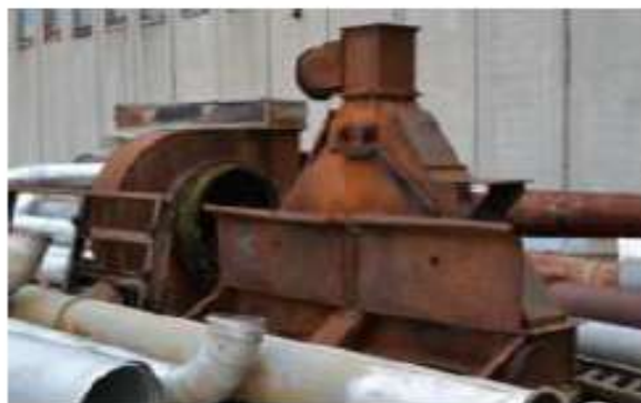
Slika 8. Dijelovi sustava dimnjaka ( ciklon )
